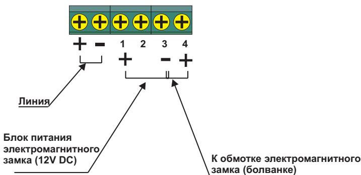
В случае применения электромеханического замка, для коммутации тока управления замком, следует использовать клеммы №1,2. (рис.2, 3)
