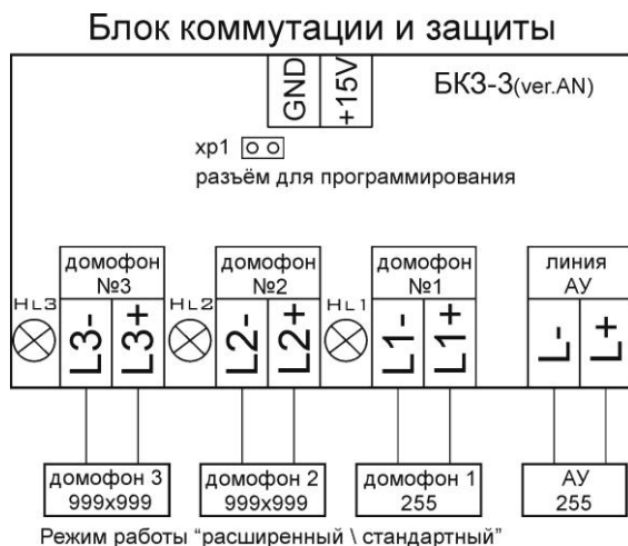
Рис.5 Подключение к блоку коммутации и защиты БК3-АН
