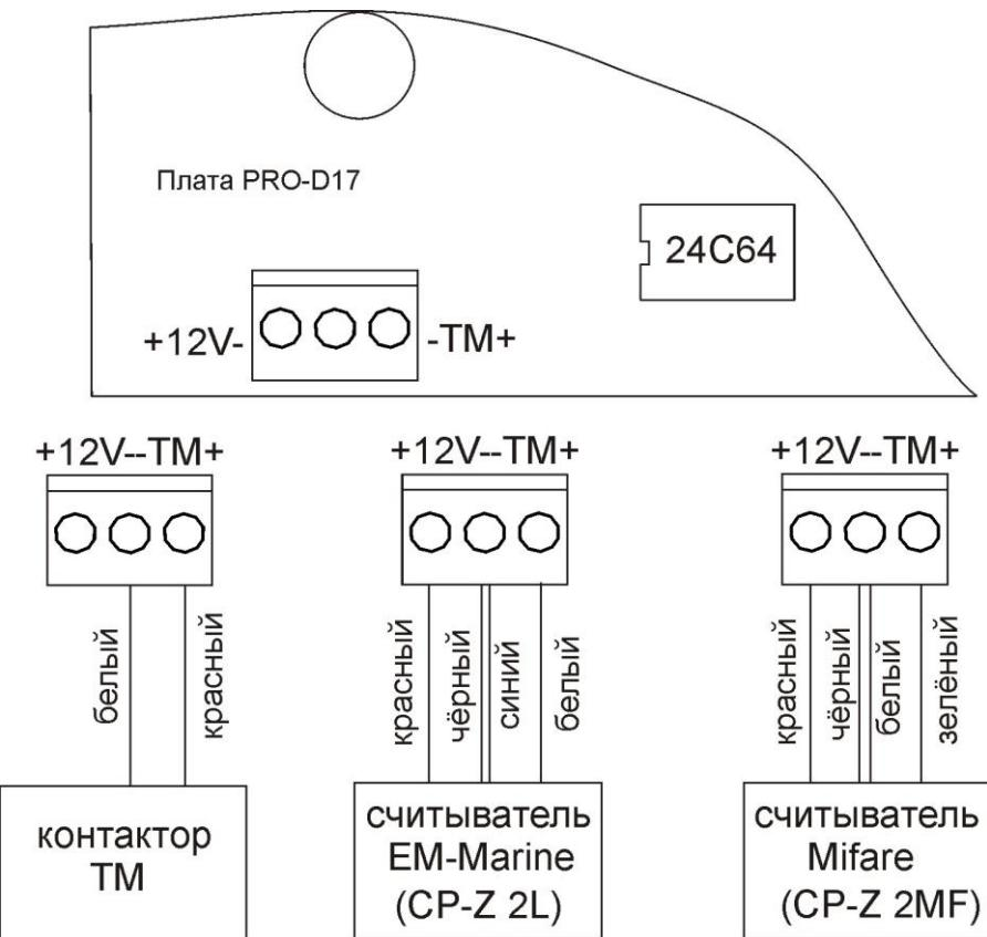
Рис.26 Возможные варианты внутрисхемного подключения
